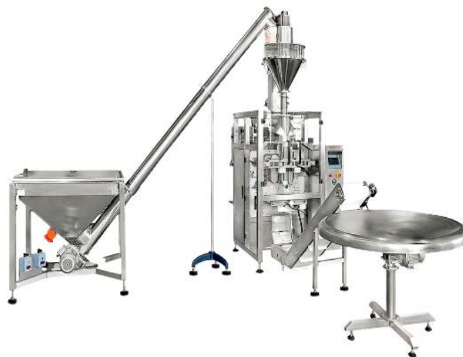
Ilustración 25: Envasadora Flowpack Vertical Brunetti AG420F. Fuente: https://brunettihermanos.com.ar/categorias/envasado/verticales-11922.html
