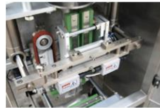
Ilustración 26: Envasadora Vertical AG420F con servomotor. Fuente: https://brunettihermanos.com.ar/categorias/envasado/verticales-11922.html
