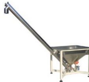
Ilustración 27: Elevador Z con tolva vibratoria.
