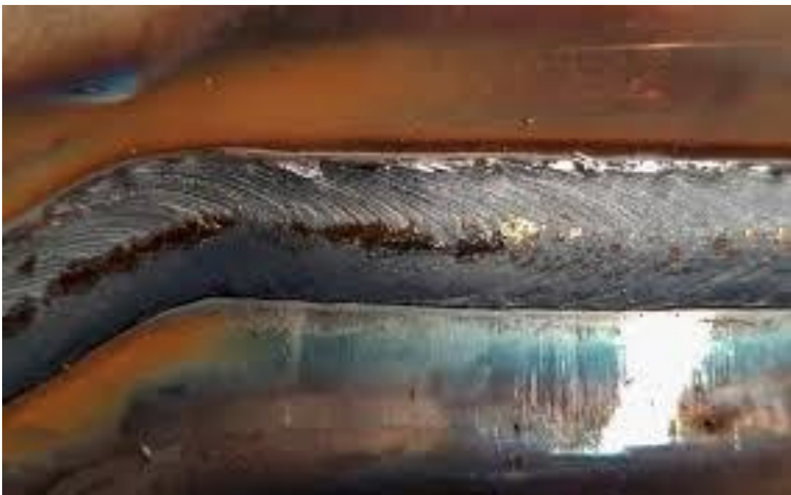
Soldadura con acero inoxidable antes de ser pulida.
