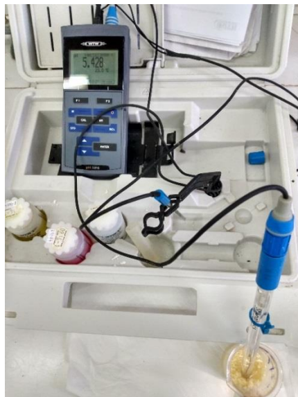
Figura 7: Medición de pH en queso blando de acuerdo al método potenciométrico estándar de la APHA (Bradley et al. , 1993).
