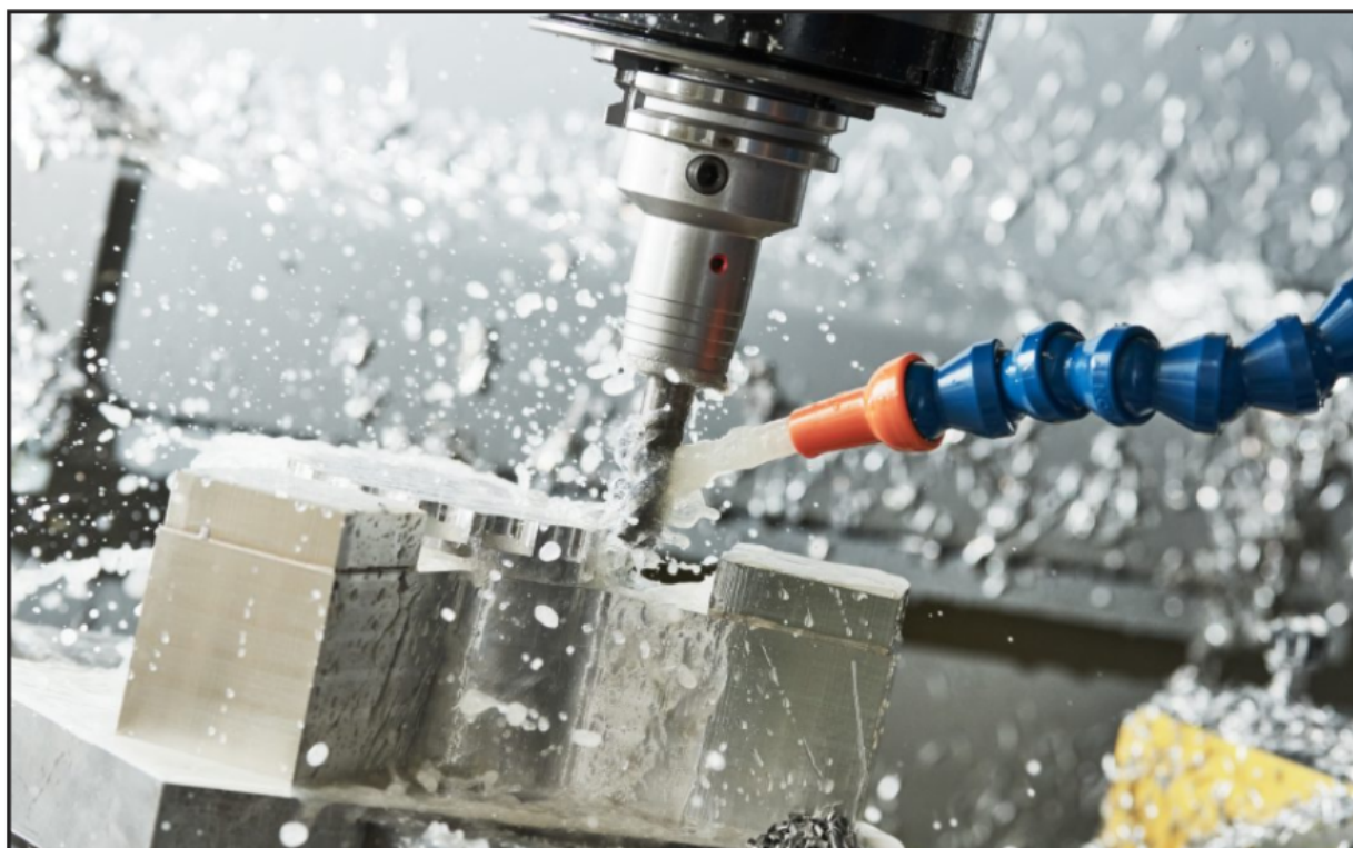
Corte de cnc con lubricación por solución con aceite.
