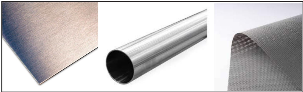
Los pilares en cuanto a materialidad para el desarrollo de este productos son chapa y caño de acero inoxidable, más lona microperforada.
