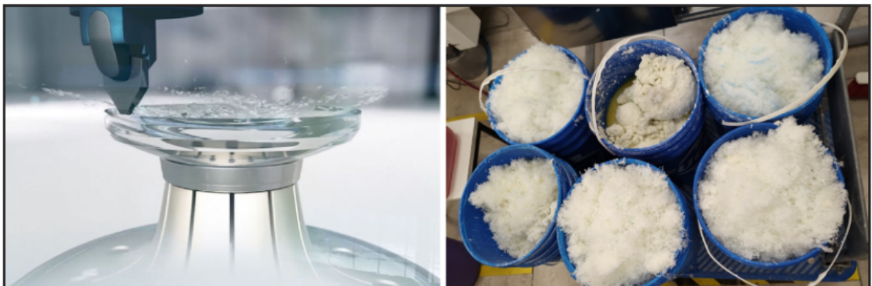
En el barrido del corte del lente se produce scrap (viruta) del sobrante del block.
