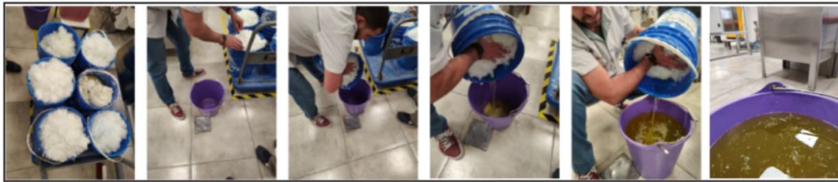
Detección de problemática en el acopio de scrap, se visualiza pérdida de solución por ausencia de filtrado adecuado.
