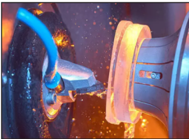
Fast tool de mono filo de diamante artificial o natural para barrido fino del lente.
