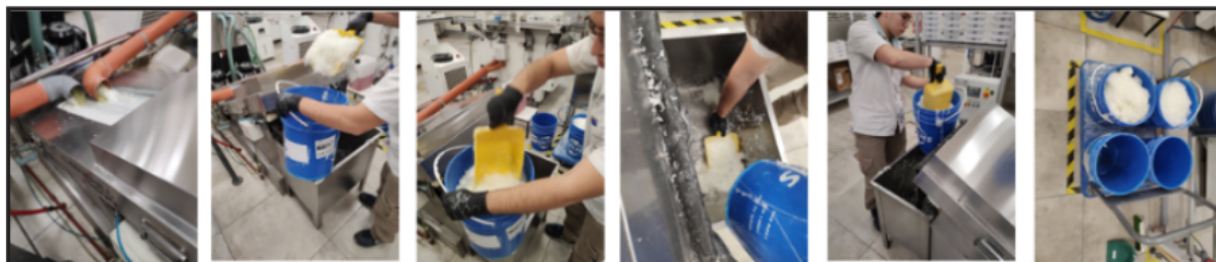
Operario del sector tallado realizando la recolección y acopio de viruta scrap producida por los generadores.
