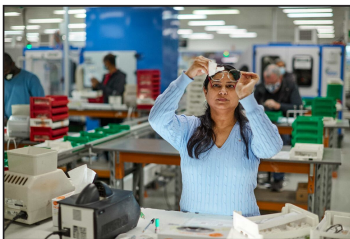
Inspección cosmética en control de calidad posterior al calibrado y ensamblado del lente.
