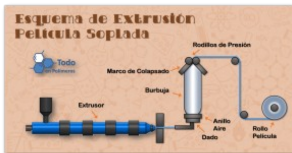
Figura 7 - Esquema de extrusión película soplada
