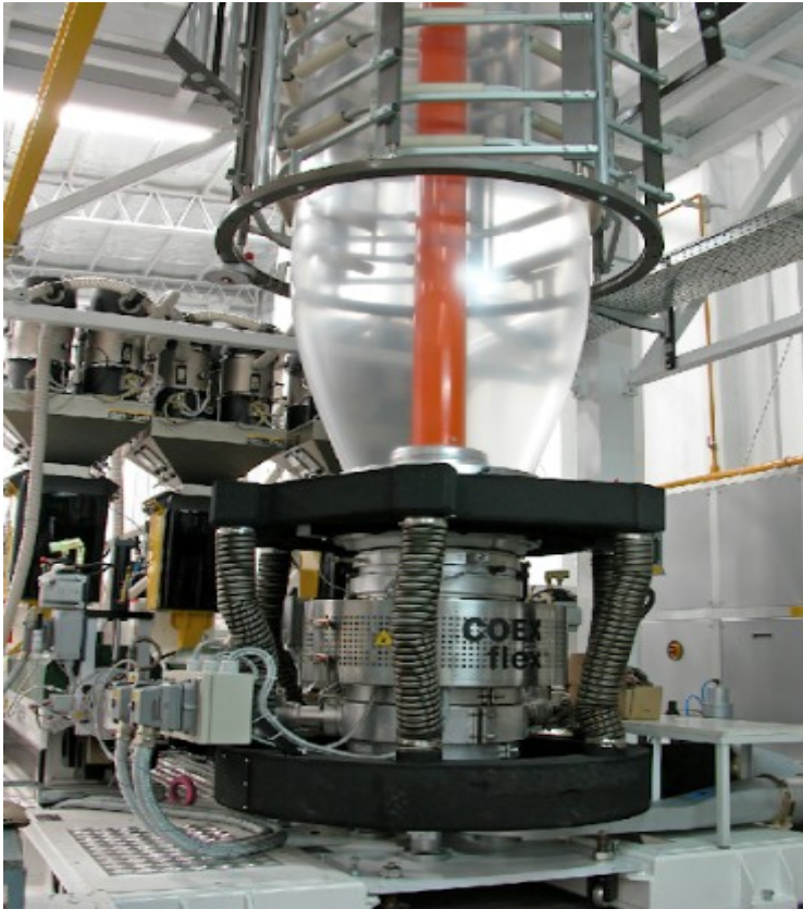
Figura 8 - Burbuja de extrusora de polietileno
