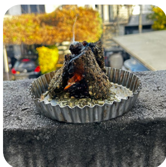
Encendido inicial de la briqueta. Se observa la combustión al inicio, donde la llama comienza a prender el material.
