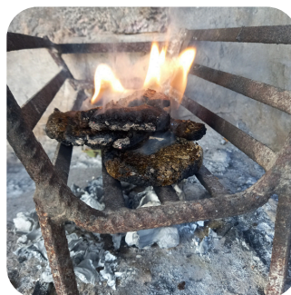
Aplicación en asador. Prueba de la briqueta como sustituto de otros combustibles para cocinar.
