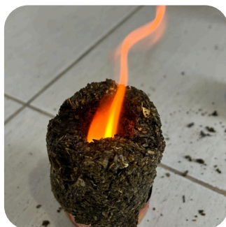
Llama sostenida. Ejemplo del comportamiento de la briqueta durante la quema, mostrando su potencia calorífica.
